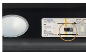
Le capteur magnétique contrôle les propriétés magnétiques.
