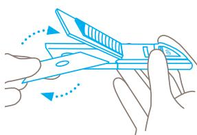
Retirez et retournez ou changez la lame. Veillez à bien réinstaller la lame en la plaçant **exactement** sur l'ergot.
