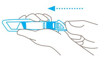
Refermez le cache-lame et repoussez l'insert en plastique dans le manche jusqu'à ce que le bouton de changement de lame fasse un **déclic**.
